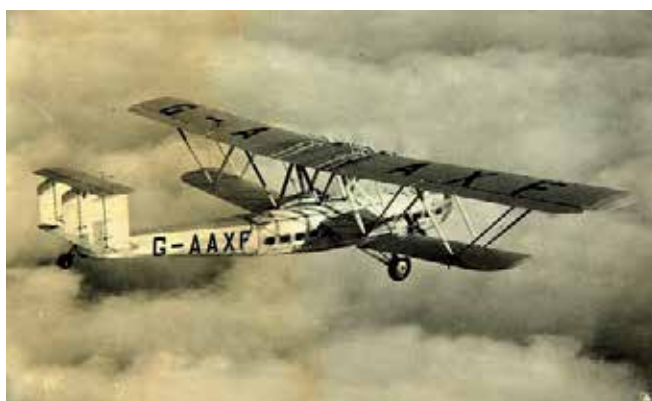
Handley Page HP 45 (Helena) em pleno voo. Esta variante era equipada com quatro motores Jupiter XFBM Supercharged de 555 HP cada. Foram fabricadas quatro unidades deste modelo.
