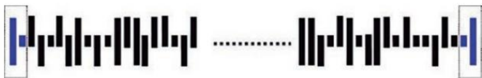
Figura E – Formato geral do código de barras 4-state com as barras de início (start) e fim (stop), totalizando 60 barras.
