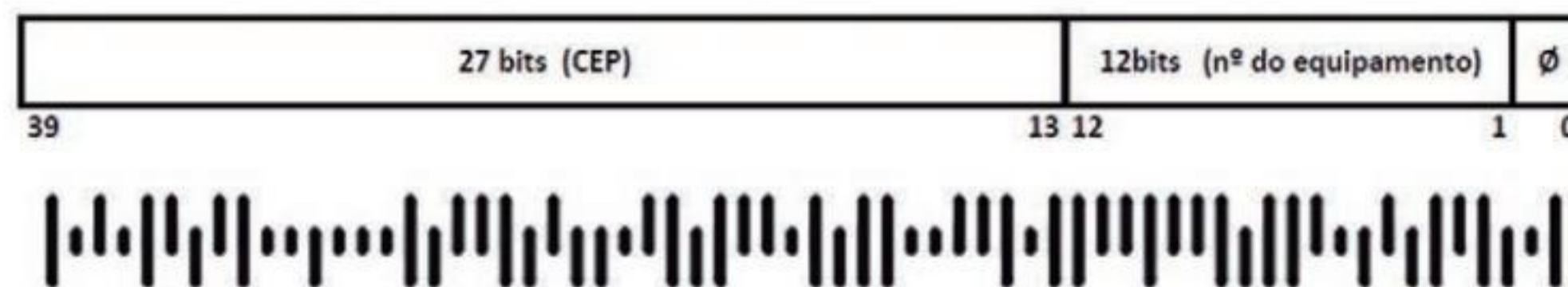
Figura F – Exemplo de um código de barras de Destino (CD) completo.
